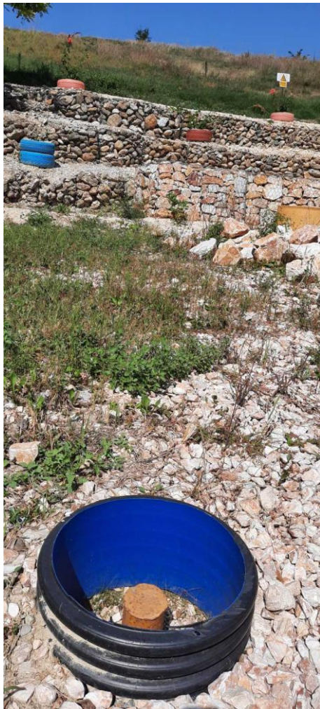
Слика бр. IX-5 и слика бр. IX-6 : Пиезометар на мерно место MM1 и MM2
