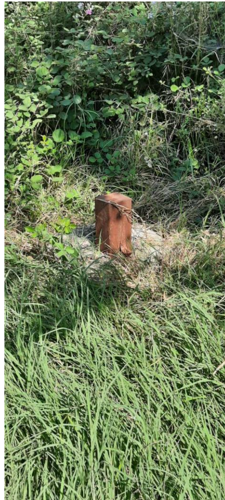
Слика бр. IX-5 и слика бр. IX-6 : Пиезометар на мерно место MM1 и MM2
